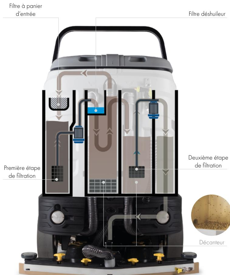
**1.** La solution utilisée pour le nettoyage des sols est collectée dans le bac de récupération où elle passe à travers le filtre à panier afin de retenir les petits résidus solides.
