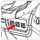
La machine peut être équipée de lumières de courtoisie pour augmenter la visibilité des parties qui pourraient nécessiter des contrôles de la part de l'opérateur. Pour activer ces feux, il suffit d'appuyer sur l'interrupteur central dans la colonne de direction.
