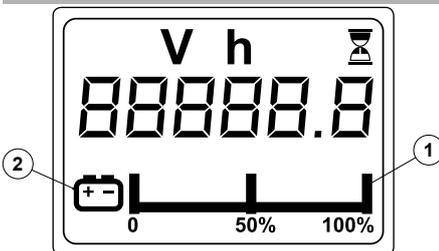
L'écran de commande est présent dans le panneau de commande. Sur l'écran de commande, en bas, se trouve le symbole graphique qui identifie l'indicateur de niveau de charge des batteries.
