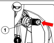
La machine est dotée d'un signal sonore, s'il est nécessaire d'effectuer un quelconque signal sonore, il suffit d'appuyer sur le bouton (1) présent dans le levier de commande de marche (Fig. 1).
