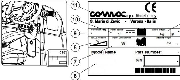
1. La valeur exprimée en kg du poids des batteries d'alimentation de l'appareil.
