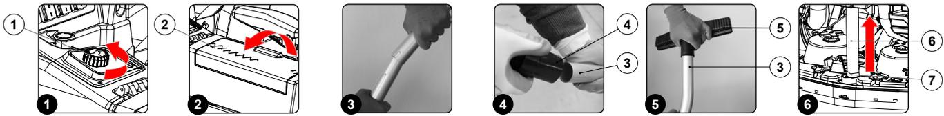
7. Raccorder le flexible d'aspiration du kit lance d'aspiration de liquides (4) au flexible d'aspiration du suceur (5) (Fig. 7).
