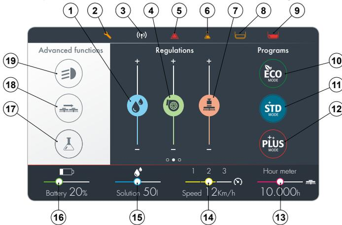
1. Indicateur de réglage du débit de solution détergente dans le circuit d'eau de la machine.
