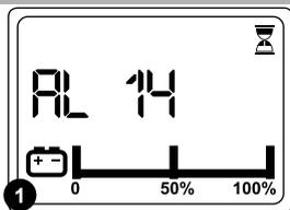
Pour les versions essential, lorsqu'une erreur se produit, l'écran de commande affiche l'inscription AL suivie d'un numéro (Fig. 1), qui restera visible jusqu'à la résolution de l'erreur.
