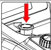
En cas de graves problèmes de sécurité pendant le travail, appuyer sur le bouton d'arrêt d'urgence placé sur le carter de protection de l'installation électrique.
