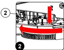
2. Appuyer sur le pivot d'arrêt de la brosse (2) (**Fig. 2**).
