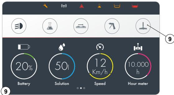
**i** **REMARQUE** : dès qu'on appuie sur l'interrupteur (8) ou sur le bouton (9) le moteur d'aspiration est actionné et il est possible d'effectuer le travail de séchage.
