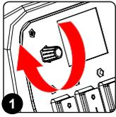
Si, pendant le travail, il est nécessaire de modifier le débit de la solution détergente sur les brosses, agir simplement sur la molette du panneau de commande (Fig. 1).
