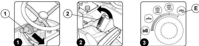
4. Sélectionner le programme de travail « lavage » (E) (Fig.3), tourner la molette de réglage i-drive (3) dans le sens indiqué par la flèche (Fig.4).
