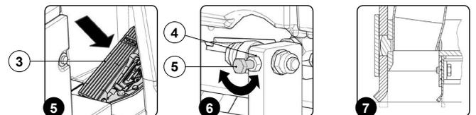
11. Pour effectuer le réglage de la partie extérieure du bourrelet du corps du suceur, desserrer la molette (6) et visser ou dévisser le pivot (7) jusqu'à ce que le bourrelet pare-projections soit plié vers l'extérieur de manière uniforme sur toute sa longueur d'environ 30°- 45° par rapport au sol (Fig. 7).
