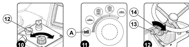
24. Placer le levier de direction (14) en position « marche arrière », déplacer le levier dans le sens indiqué par la flèche (Fig. 13).
