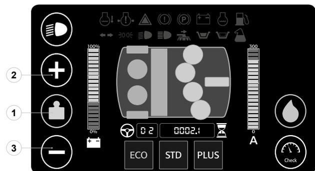
S'il est nécessaire de modifier temporairement la pression exercée sur les brosses pendant le travail, il suffit d'appuyer sur le bouton (1) présent sur l'écran de commande.
