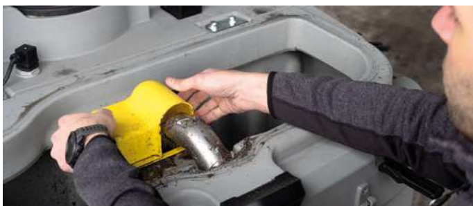
Filtre panier pour bloquer les éventuels déchets et éviter qu'ils ne se déposent sur le fond du réservoir de récupération.
