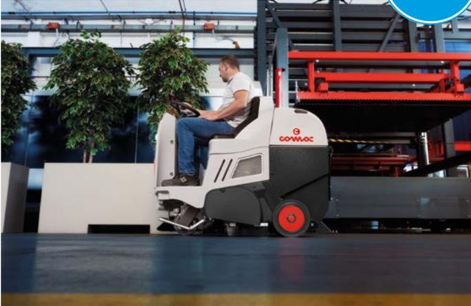
Dans la version à batterie, les différentes fonctions (brosses, traction, aspiration) sont activées par des moteurs dédiés. L'autonomie peut atteindre les 4 heures effectives, soit 20.000 m<sup>2</sup> nettoyés sans émissions.
