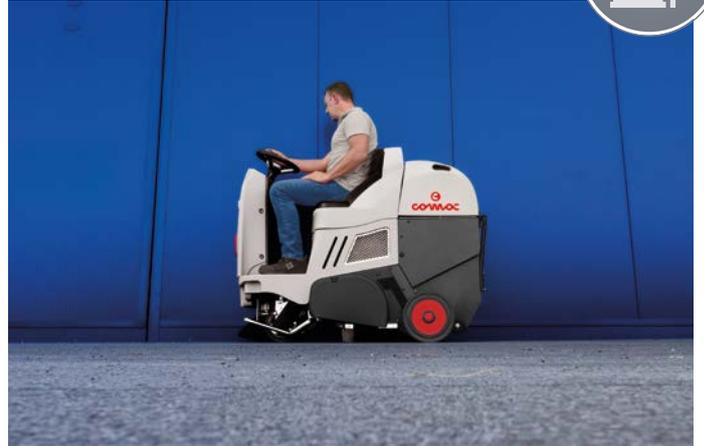
Les versions à moteur à combustion (CS700 H et CS800 H) sont équipées d'un système hydraulique complet et dépourvues de cartes électroniques. Cela permet une meilleure fiabilité et garantit la plus grande tranquillité de l'opérateur dans des situations de saleté tenace.
