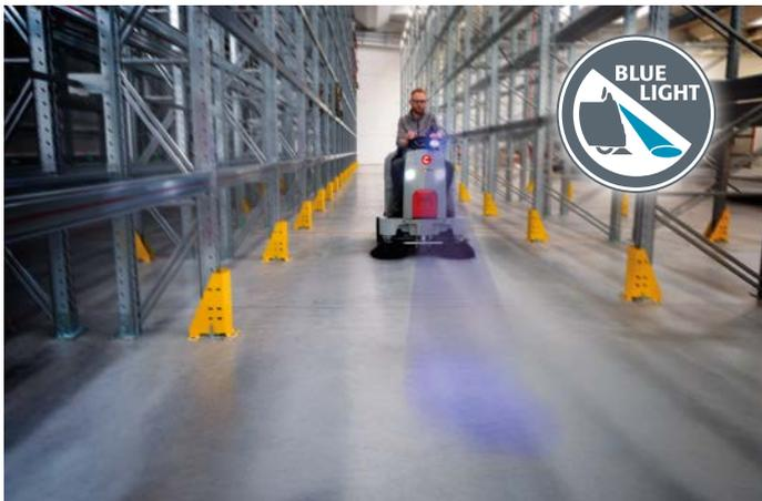
CS700 et CS800 peuvent être équipées du **Blue Safety Spotlight** la technologie qui projette un faisceau de lumière sur le sol pour signaler à l'avance la présence de l'autolaveuse, augmentant ainsi la sécurité.
