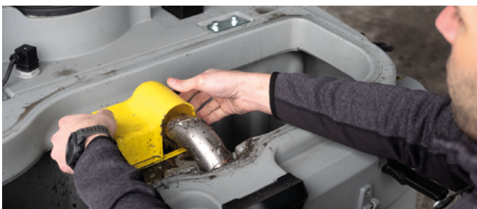
Filtre panier pour bloquer les éventuels déchets et éviter qu'ils ne se déposent sur le fond du réservoir de récupération.
