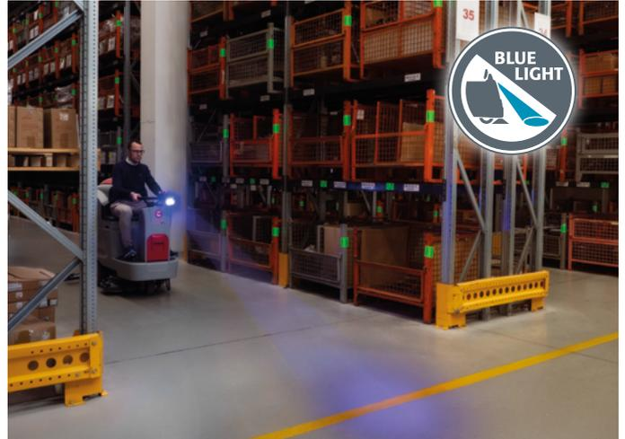
Innova peut-être équipée du **Blue Safety Spotlight** la technologie qui projette un faisceau de lumière sur le sol pour signaler à l'avance la présence de l'autolaveuse, augmentant ainsi la sécurité.
